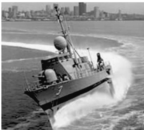
**Figura 3** – PHM, embarcação militar com hidrofólios desenvolvida pela Boeing
