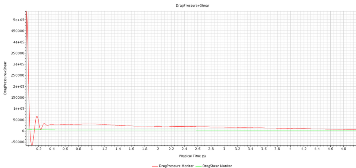
Figura 149 – Componentes de resistência ao avanço viscosa e de pressão em tempo físico de 5s avaliadas para a velocidade de 5.0 m/s
