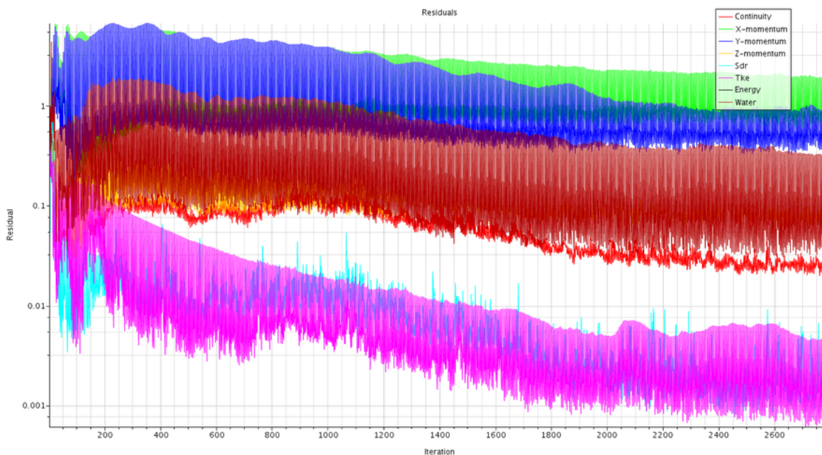
Figura 91 – Resíduos gerados em um tempo físico de 5s, na velocidade de 0.6 m/s
